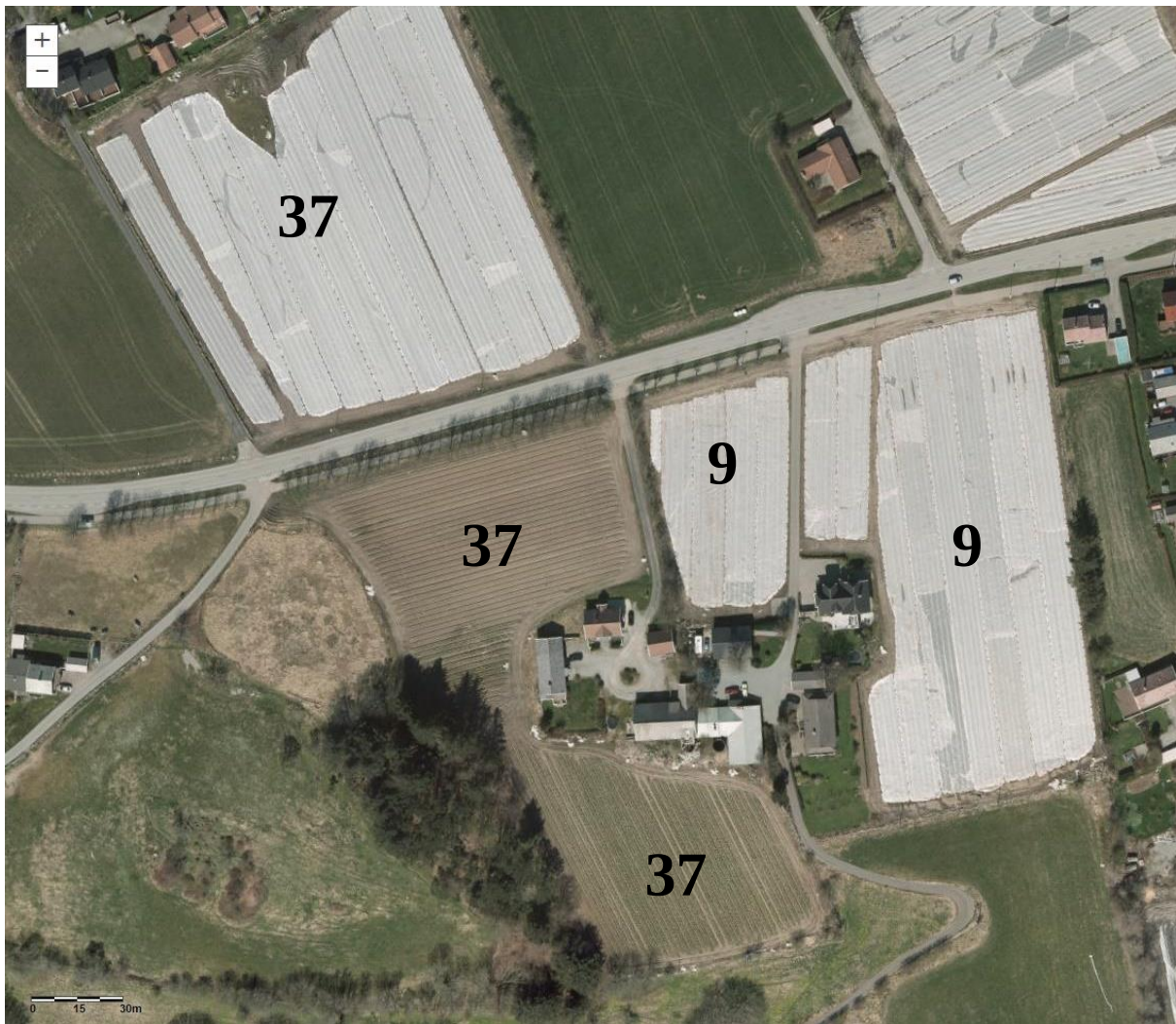
Figur 64: Teig 37 og teig 9 har truleg god drenering, med helling i sørleg retning i nedre halvdel av teigane, sør for Kvernevikvegen. Steingardar og grasdekte marker vil gje sedimentering av eventuelle partiklar. Kjelde: Norge i bilder.
