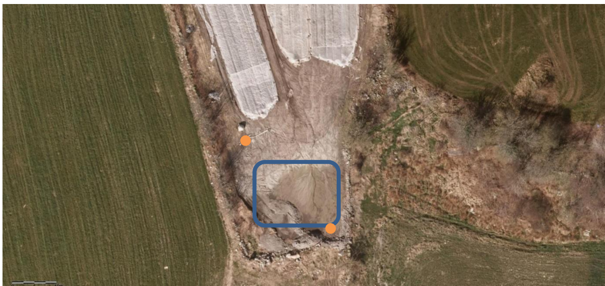
Figur 70: Ved å anleggje ein sedimentasjonsdam med heva utløp vil ein få effektiv sedimentering og redusert avrenning frå teigen. Oransje punkt markerer dagens to kummer.
